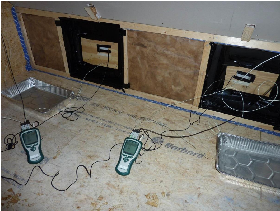
B4: Billede af prøvelfelter VA og VB på vægflade (dataloggere på testhusets gulv).
