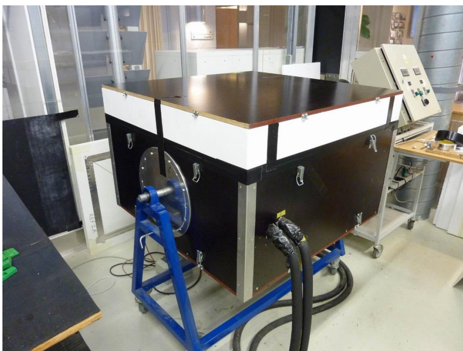
Foto 6. Prøveemne nr. 1 i målekasse, klar til måling
