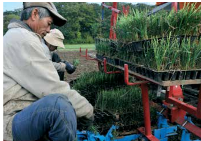
Minh Nanngoyen og hans hustru Phong sidder bag på maskinen og tager planterne fra kasser over på et roterende hjul, der varsomt sætter planten i jorden.
