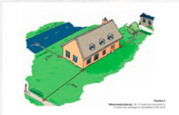
Figur 1: Afstande til skel (fra veludført stråtag)
