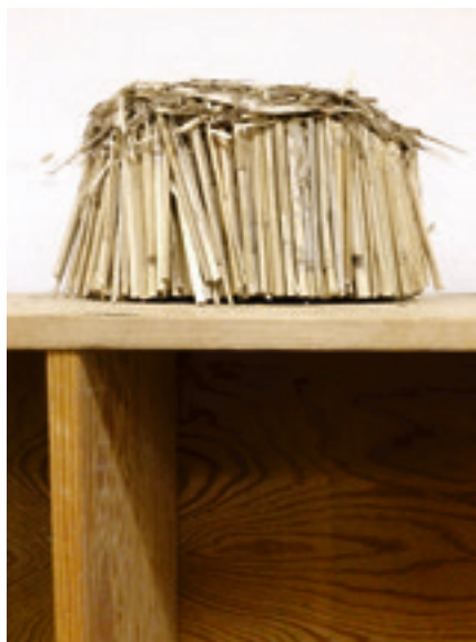
Prototype 1 - Indledende forsøg med fastgørelse af tækkerør (rør) på en limet bund af tækkerør.
