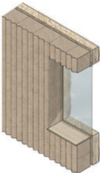
Byggeklods variation B Formet byggeklods for indre struktur Naturfarvet byggeklods 300 x 300 x 400
