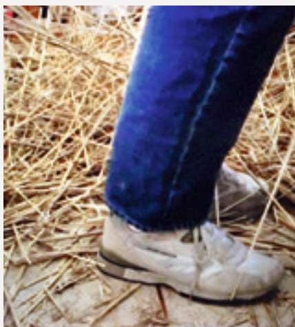
Fremstilling ved brug af løbbinding til konstruktionselementer – herunder 'værktøj' til at føre tækkerørene frem i en ensartet konstruktionstykkelse
