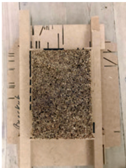
Prototype 1 - Indledende forsøg med fastgørelse af tækkerør (rør) på en limet bund af tækkerør.
