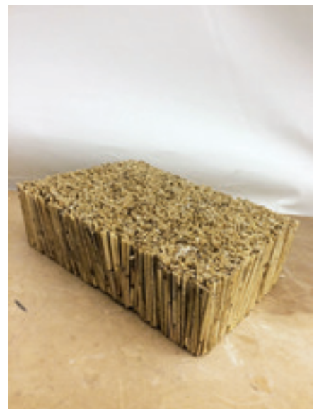
Prototype 1 - Indledende forsøg med fastgørelse af tækkerør (rør) på en limet bund af tækkerør.
