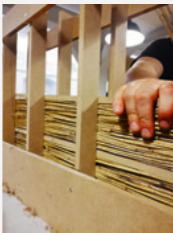
Første forsøg med tækkeelement hvor stavernes er lagt vandret. I den endelige udgave er de lagt og monteret lodret.
