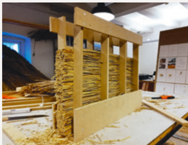
Første forsøg med tækkeelement hvor stavernes er lagt vandret. I den endelige udgave er de lagt og monteret lodret.
