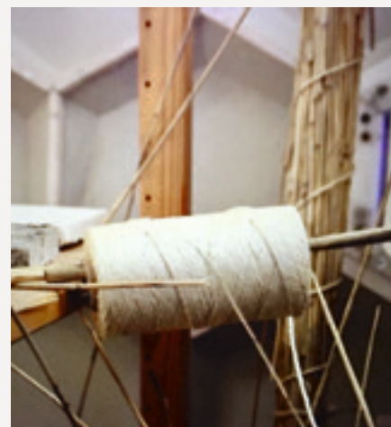
Fremstilling ved brug af løbbinding til konstruktionselementer – herunder 'værktøj' til at føre tækkerørene frem i en ensartet konstruktionstykkelse
