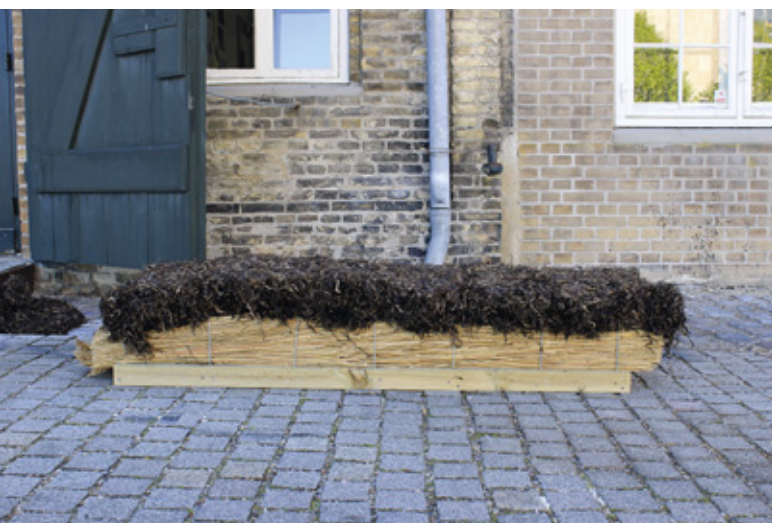
Lise med tang til prøvetaget i København. En demo-model af det kombinerede tang- og stråtag var en del af afgangsopgaven.
