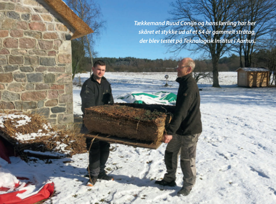
Her gøres klar til at teste et gammelt, nedtaget stråtag for varmeisoleringssevne på Teknologisk Institut i Aarhus.
