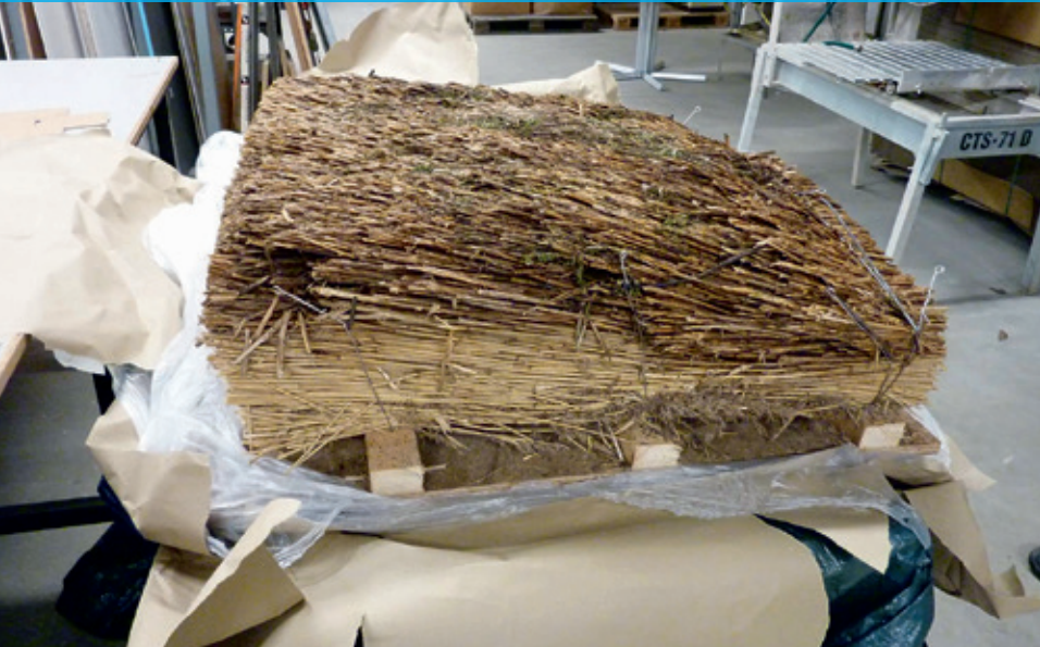
Her gøres klar til at teste et gammelt, nedtaget stråtag for varmeisoleringssevne på Teknologisk Institut i Aarhus.
