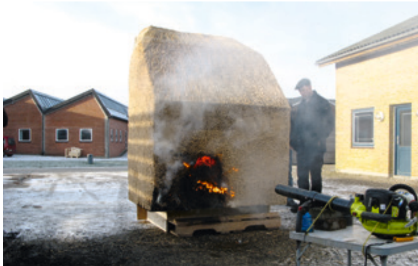
Brandforsøg med lodret tækning på Den jyske Haandværkerskole til det faglige seminar i januar 2020. Nu skal forskellige typer klimavenlig brandsikring testes i dette projekt, som er støttet af Miljøstyrelsen.
