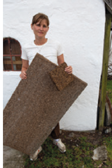
Ålegræsset vrides sammen i de såkaldte vaskere, der flettes ind i de nederste tre lægter på taget. Her dannes en vold, hvorpå der oplægges et meter tykt lag ålegræs. Kirsten Lyngbe med et par vareprøver, isoleringsmætter lavet af ålegræs
