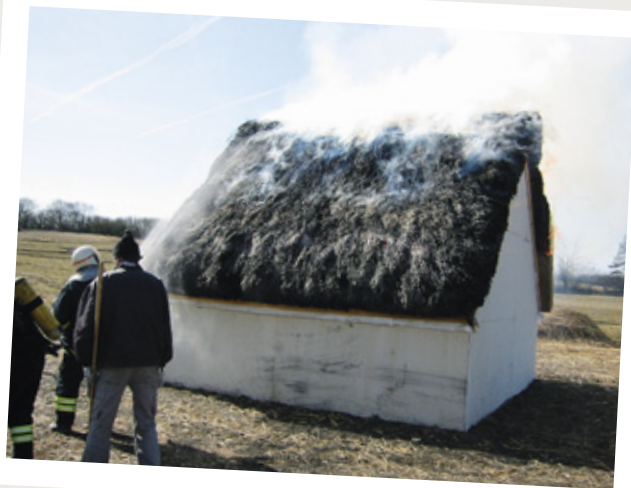
Brandtest i 2003. Det Sepatec-brandsikrede prøvehus bestod prøven, som blev nøje overvåget af DBI. Siden da har Sepatec været godkendt som brandsikring.
